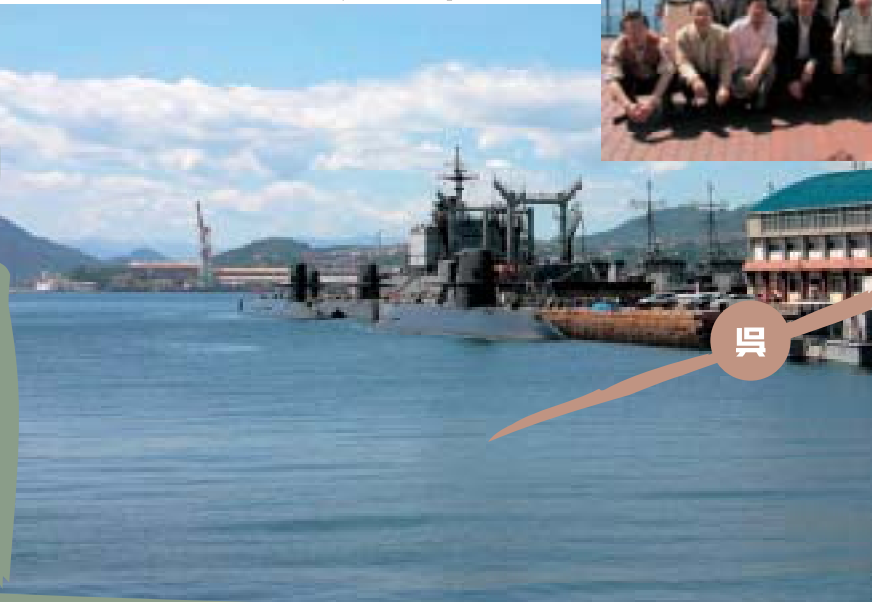
「てつのくじら館」(海上自衛隊呉資料館) 日本初、陸揚げされた本物の潜水艦。 全長：76.2m(ジャンボジェット機並み) 重さ：約2,250トン 乗員：75名
